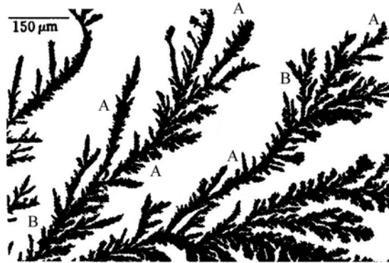
图1.4.4.6-4 FeSO_4 电解沉积结晶形貌, A为枝晶, B为密枝。
