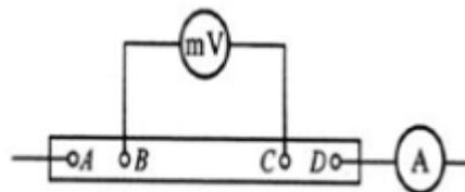
图 7-4 四端接法电路图
