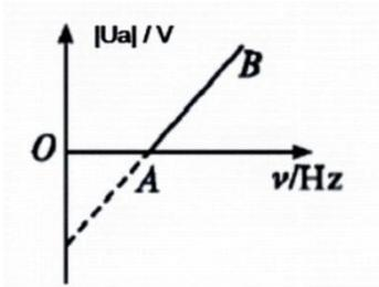
8. 如图所示，表示发生光电效应的演示实验，那么下列选项中正确的是（灵敏电流计不显示读数，可能是因为入射光频率过低；发生光电效应时，光电子是从 k 极跑出来）
