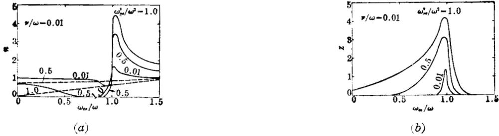
图 6.2.4 在  $\nu/\omega=0.01$  时沿磁场方向传播的左、右旋波的  $n, \alpha$  值随  $(\omega_{pe}/\omega)^2, (\omega_{ce}/\omega)$  变化的曲线
