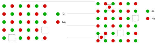
包含两个Na + 离子填隙弗仑克尔缺陷的NaCl晶体
