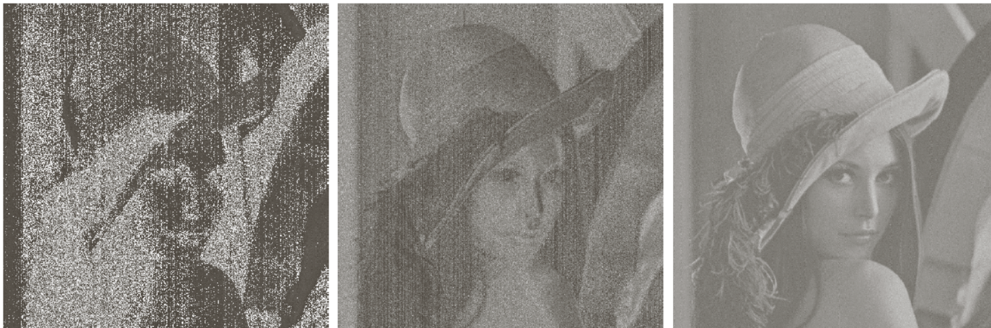
上图(d)中带噪声的彩色图像的HSI分量：(a)色调图像；(b)饱和度图像；(c)亮度图像
