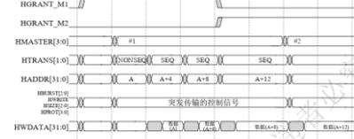
图 4.32 突发传输的总线移交
