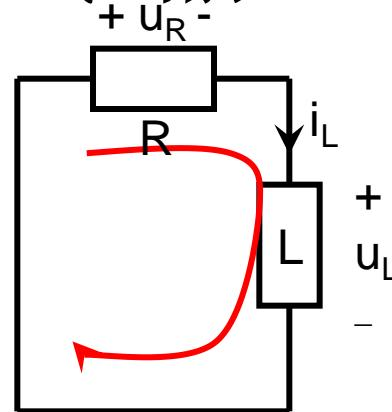
$$1. \quad t < 0, i_L = I_0 \Rightarrow i_L(0^+) = i_L(0^-) = I_0$$
