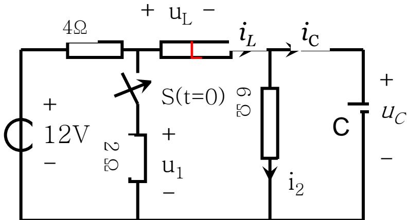
Step 1: 换路前电路状态, 此时为直流电路, 电容开路, 电感短路, 计算电容电压和通过电感的电流
