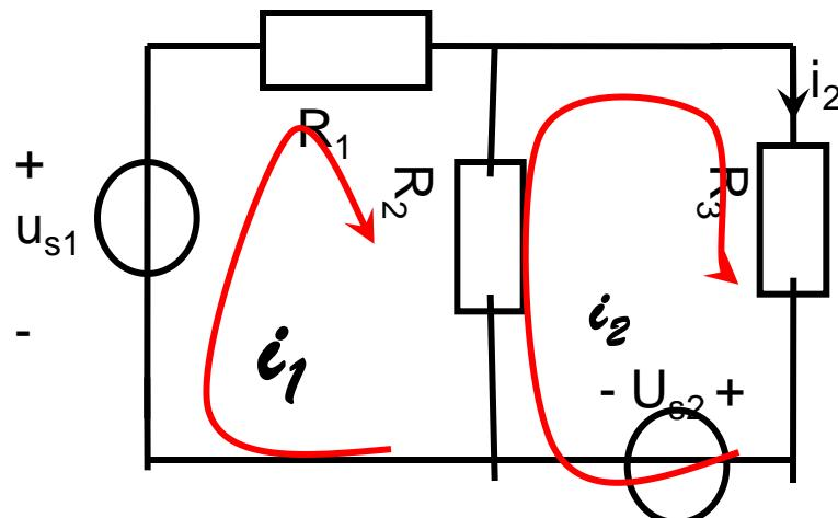
$$\begin{bmatrix} R_1 + R_2 & -R_2 \\ -R_2 & R_2 + R_3 \end{bmatrix} \begin{bmatrix} i_1 \\ i_2 \end{bmatrix} = \begin{bmatrix} 38V \\ -12V \end{bmatrix}$$
