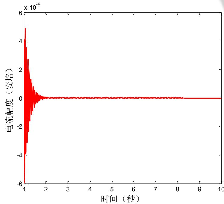
$R = 1\Omega$ ,  $L = 0.1H$ ,  $C = 0.001F$ 的RLC串联电路的暂态过程
