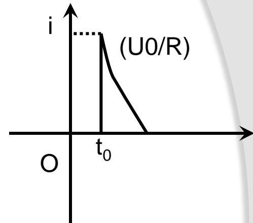
注意在系统电流为冲击的情况下电容的电压不再保持连续，和以前讲述的电容电压是连续量不矛盾，后者存在的前提是电流是一个有界函数
