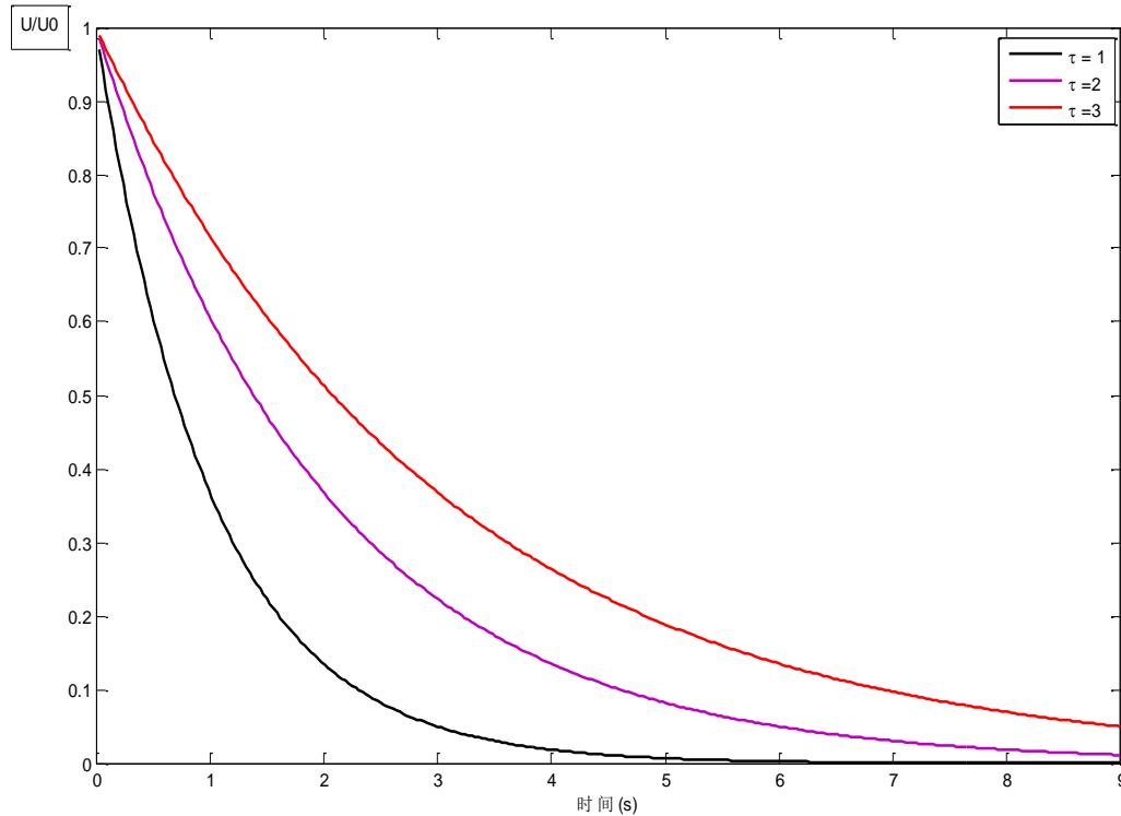
图中给出了不同的时间常数下的零输入情况的RC电路的电压曲线，横坐标为时间单位为 $\tau$ ，纵坐标的是 $U/U_0$ ，可以看出随着时间常数的增加放电时间变长
