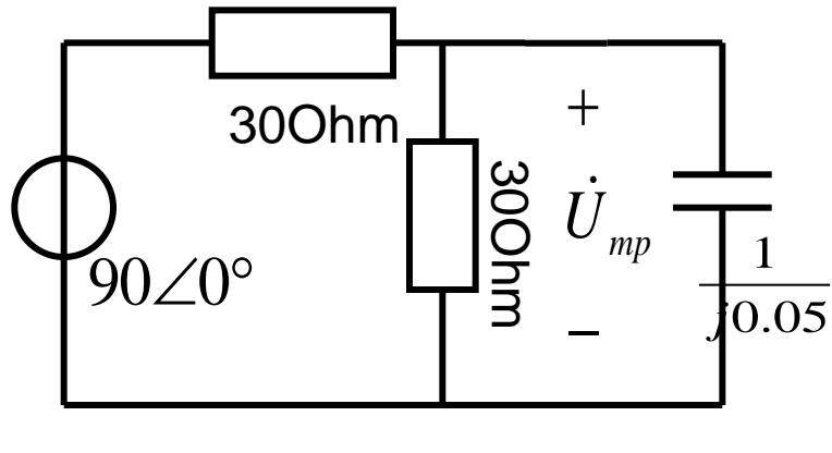
Step4: 求系统的特解,  $t > 0$ , 写出电路的相量形式, 利用节点电压法求解
