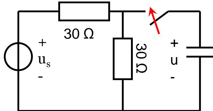
$C=0.001F$ ,  $u_s$ 是正弦电压源，幅值为90V, 角频率为50rad/s,  $u_s$ 为正的最大值时，开关接通，开关接通前电容电压为10V, 求开关接通后电压u的变化规律
