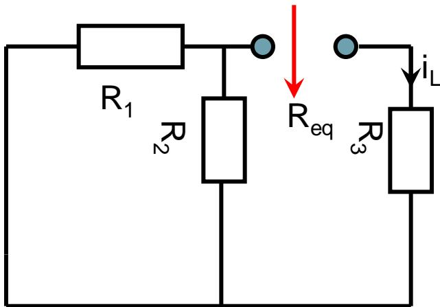
Step2: 求时间常数, 仅仅需要求出在电源置0后从电感2端看进去的电阻。
