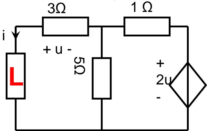
已知:  $i_L(0^-) = 10A, L = 1/6H$ , 求  $t > 0$  时电感电流  $i$  的变化规律
