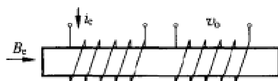
图 4.41 磁通闸门传感器至少包括一个激励线圈、一个耦合线圈和一个软铁磁性铁心。
