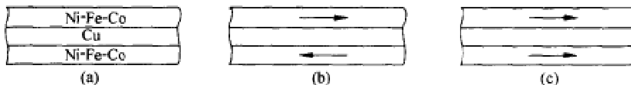
图 2.24 (a)在多层非磁性和磁性薄层中将出现非常强烈的磁阻效应。(b)磁层的净态磁化矢量方向相反:它的取向也可能是横向,即在进出纸面的方向。(c)外磁场使两个磁层的磁矩一致,因而降低这种结构的电阻。
