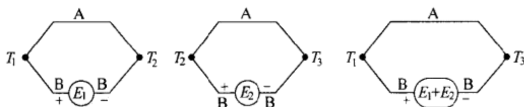
图 6.9 热电偶回路的中间温度定律。
