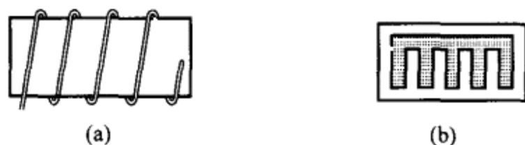
图 2.12 检测温度的铂传感器可以采用(a)缠绕电阻元件或(b)薄膜电阻元件。
