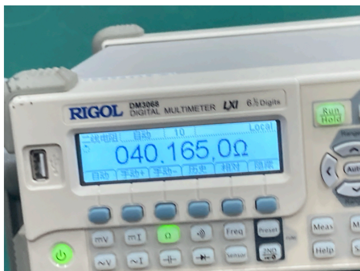
图 6: 测量螺线管电阻 2
