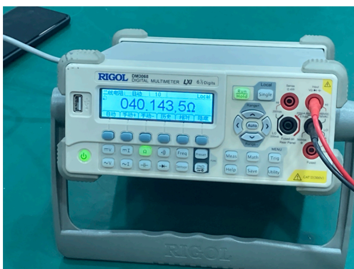
图 7: 测量螺线管电阻 3
