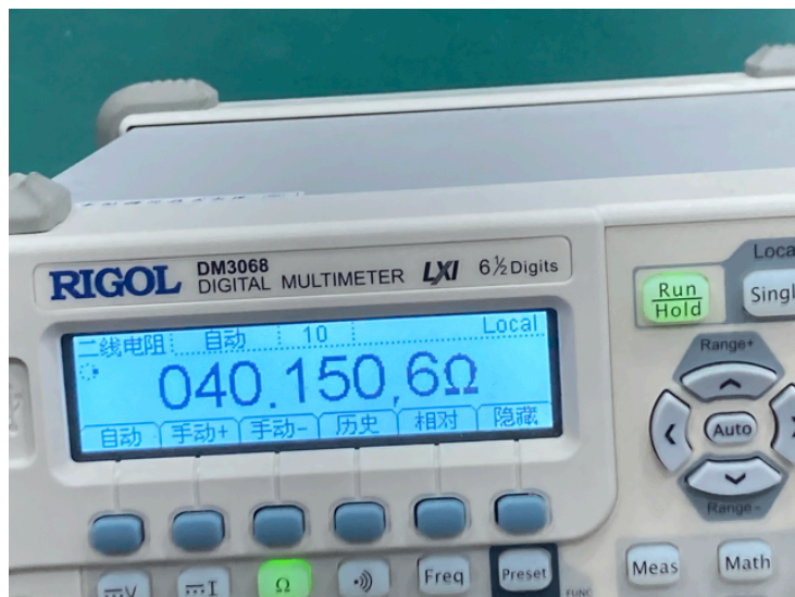
图 5: 测量螺线管电阻 1
