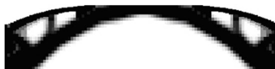
图 3 赵州桥的最佳结构分布 (拓扑优化结果)
