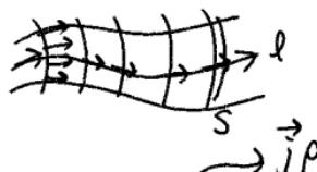
$$R = \frac{U}{I} = \frac{\int_L \vec{E} \cdot d\vec{l}}{\int j \cdot d\vec{s}} \quad \begin{matrix} \text{取场-电流} \\ \text{线/电场线} \end{matrix}$$
