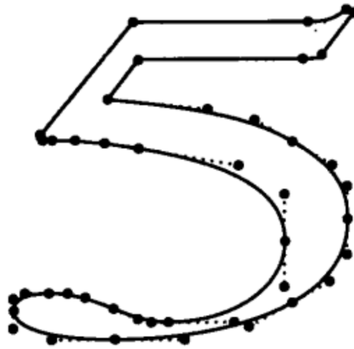
图 3-17 用 Bézier 样条制作的 Times-Roman 5: 蓝色圆是样条端点
