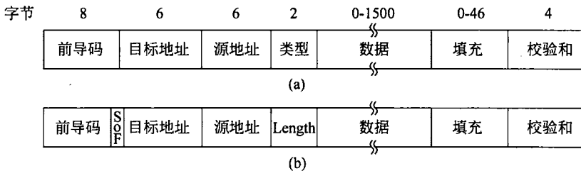
图 4-14 帧格式 (a) 以太网 (DIX)；(b) IEEE 802.3
