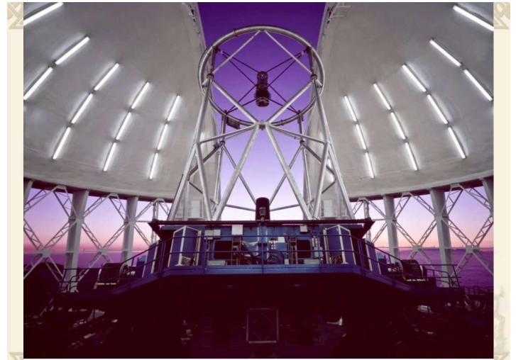
薄镜面技术——双子座望远镜 (Gemini Telescope) 两台望远镜, 主镜均为8.1米, 厚度仅为20厘米。/ NOAO
