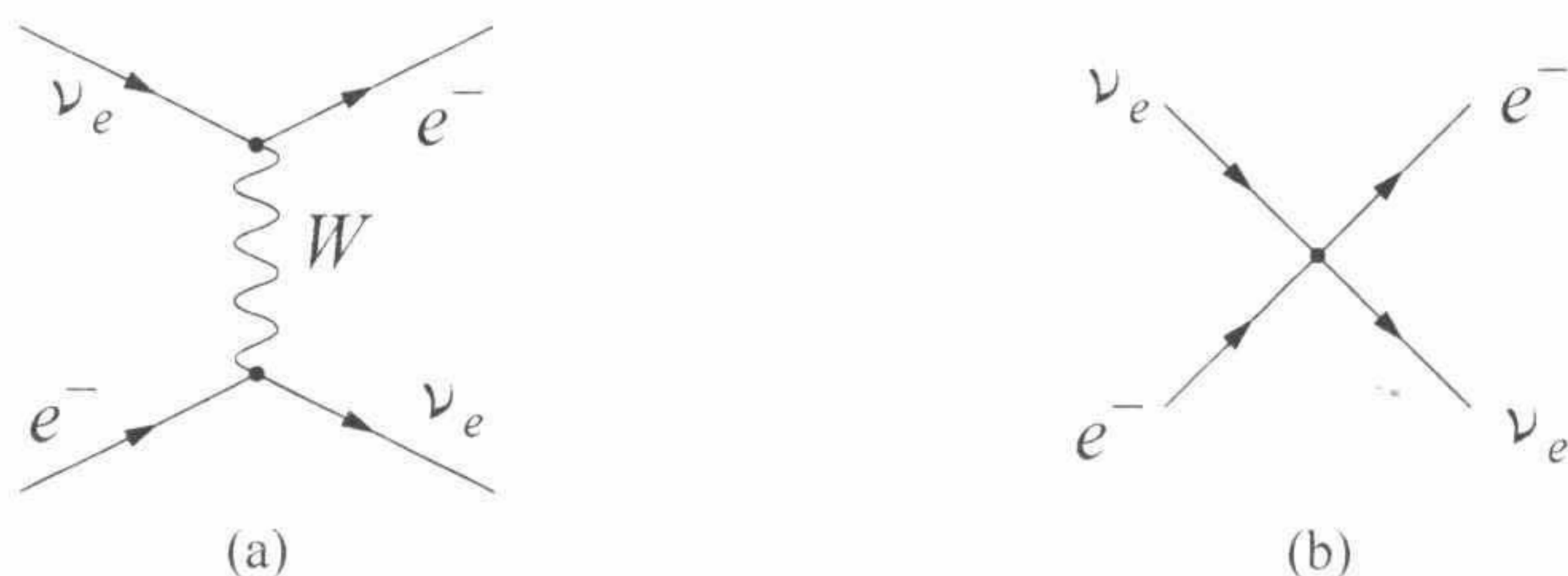
图 3.7 (a) 交换一个 W 玻色子的散射过程 e^- \nu_e \rightarrow e^- \nu_e 的领头阶 Feynman 图. (b) 费米理论中的同样过程.
