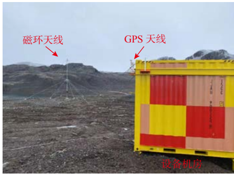
图 2 南极长城站哨声波监测仪设备安装图
