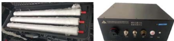
图 1 感应式磁力仪组成, 左为感应式磁场传感器, 右为数据记录器
